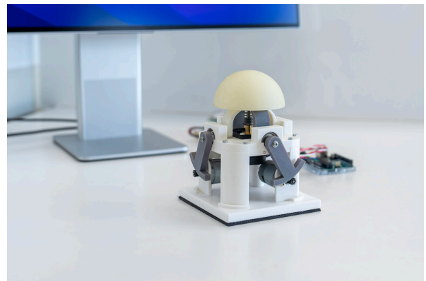
図 1: 操作感覚共有コントローラ。ジョイスティック下部に ついた 2 つのモーターで相手の操作感覚を伝送する。
