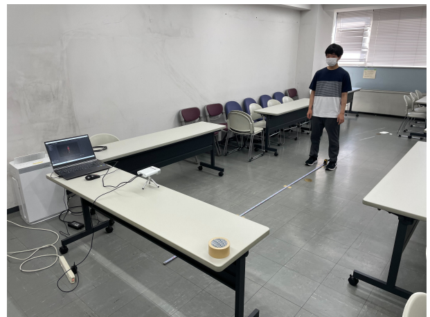
図2: Azure Kinectを用いた歩行データ計測の様子
