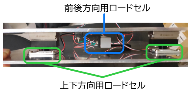
図 2: 力検出装置の構造
