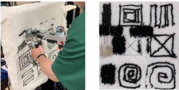
図 3: タフティングガンの使い方とタフト加工された導電性毛糸の展示
