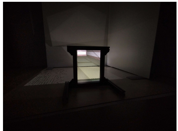
図 5: ドア枠内に映像が投影される様子（視点位置変化に応じ投影範囲や映像が動的に変わっている）
