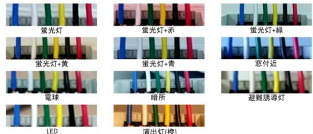
図 6: 11 種類の照明条件での配線の見え方
