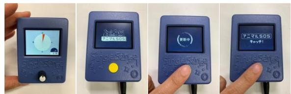
図 6: ディスプレイ表示の例（左：シーン操作デバイス画面、右 3 枚：画面遷移の様子）
