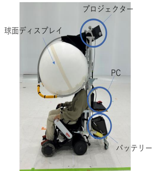
図 2: 球面ディスプレイ搭載電動車いす (側面)
