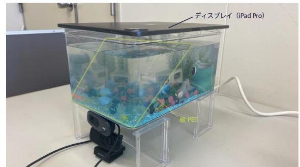
図 7: 水槽の外観と内部構造
