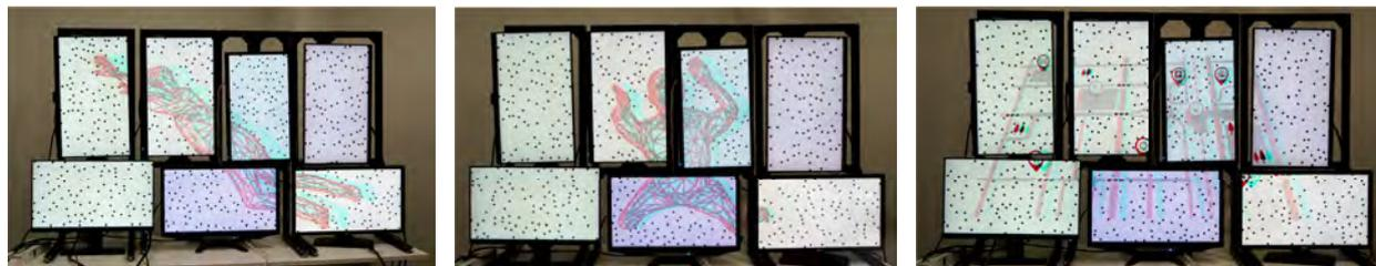
図 2: 左・中央: 水泳時の動くフォームが立体的かつ等身大に提示される様子. ディスプレイを比較的低コストで用意でき、屋外などにも設置できるため、水泳に限らないスポーツの練習時などに利用することができる。右: マップが提示される様子。駅やショッピングモールなどの公共空間に使用できる。
