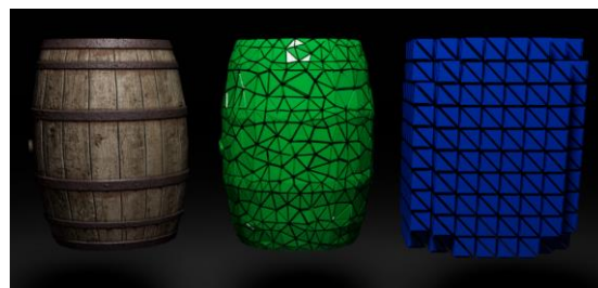
図 1: SoftBody のメッシュの例 (出典: NVIDIA) 左から Render Mesh, Collision Mesh, Simulation Mesh
