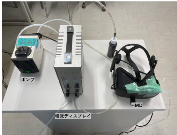
図 2: 高速電磁弁開閉型嗅覚ディスプレイと HMD
