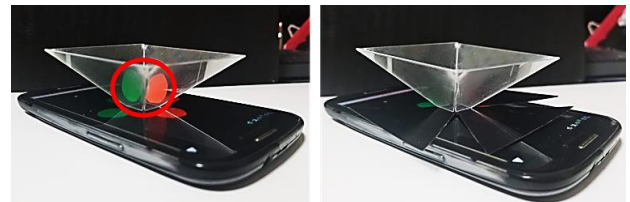
図 4 視野角制御フィルムの有無による差 (左：無、右：有)
