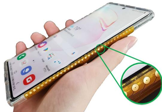
図 1: 側面電気刺激インタフェース
