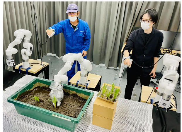
図2: トライアルの様子。操作者2人(左: 農家, 右: 初心者)が1つのロボットアバターに融合して土に稲を植えている。ロボットアバターの運動は2人の運動をそれぞれ50%ずつ足し合わせて計算した。
