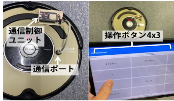
図2: 通信制御ユニットを接続したロボット掃除機とタブレット端末から操作する様子
