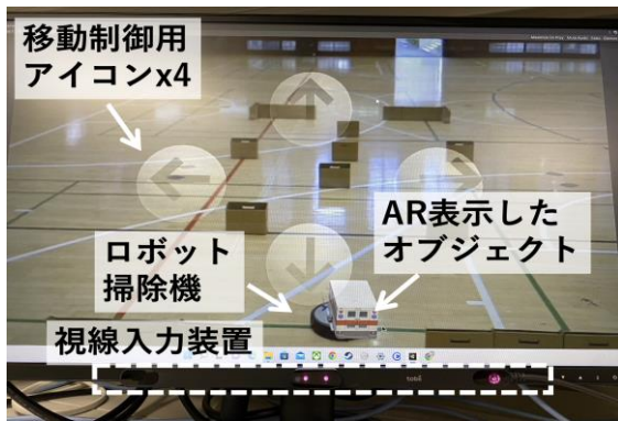
図 4: 視線入力で AR ゲームを操作する画面
