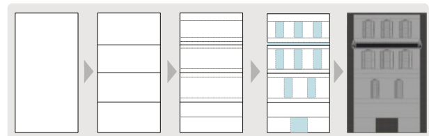
図 2: ファサード分割の流れ。面を再帰的に分割し、それぞれに面の種類を割り当てる。分割後、面の属性に従ってモデリングを行う。
