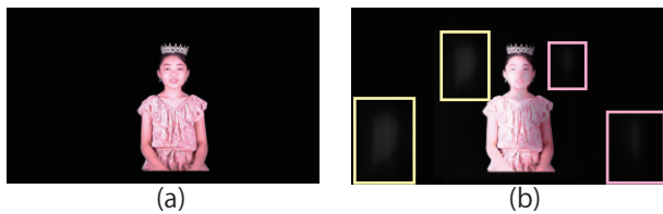
図 3: 上半身ライティングによる背景に白い領域の発生 ((a): ライティング前, (b): ライティング後) .
