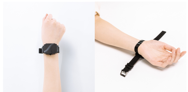
図 1: 開発したバンド型触覚デバイス。
