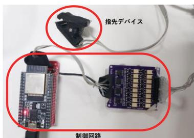
図 1: 電気刺激装置 (全体)
