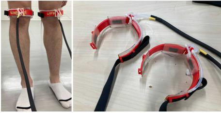
図 1: 膝部ハンガー反射デバイス (右) とその装着イメージ (左)
