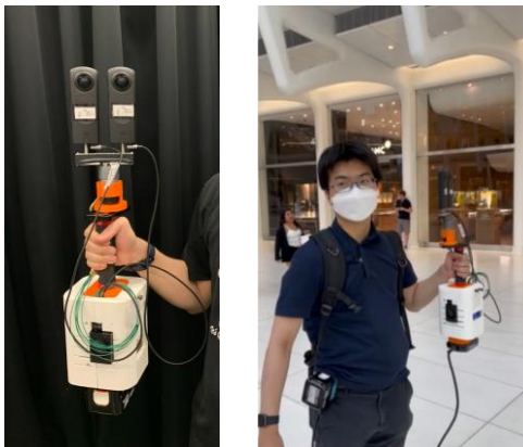
図7: 手持ち TwinCam ユニット(左)と送信現場の状況(右)
