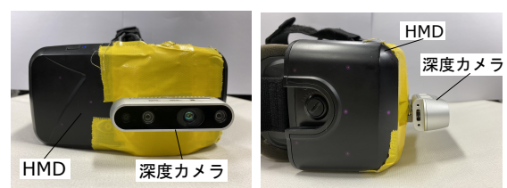
図 2: 製作した深度ビデオスルー型 HMD: 正面図 (左) と右面図 (右)
