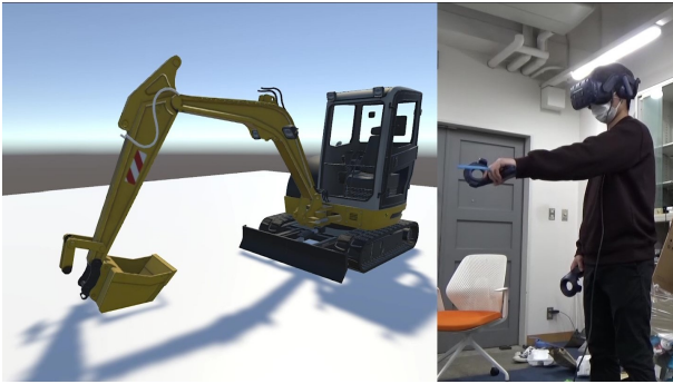
図 4: 実験の様子。実験参加者は学習器の構築後に行われる 2 回目のなりきりタスクを行っている。その動きを元にして、油圧ショベルアバタが動いている。この時の油圧ショベルアバタの様子は実験参加者の HMD には表示されず、実験者のみが確認できる。
