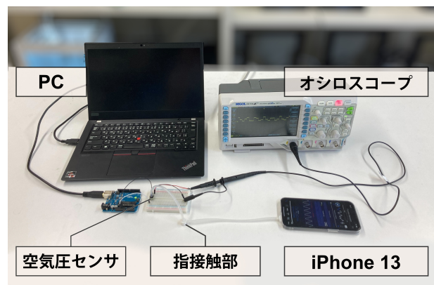
図 5: 圧力の計測を行った実験環境の様子
