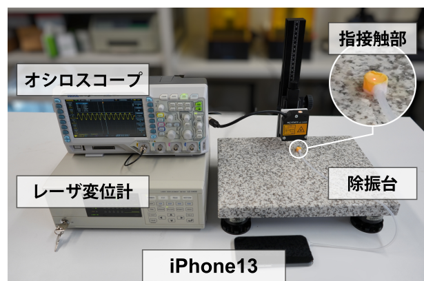
図 3: 空気振動の波形の計測を行った実験環境の様子
