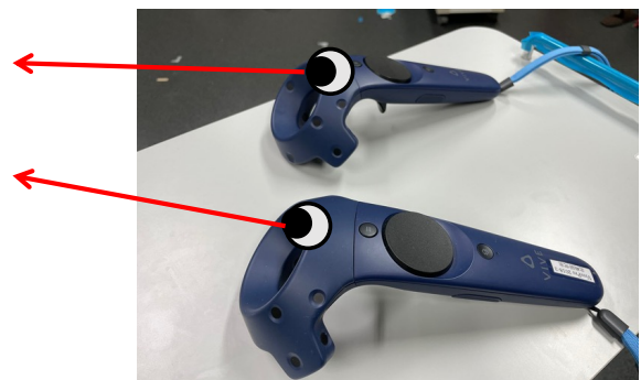
図2 ハンドコントローラーに設定したバーチャルカメラ(眼)と視線
