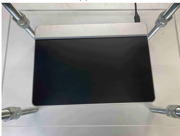
(b) 板材の裏側に接着された高感圧タッチパッド (感圧面)
