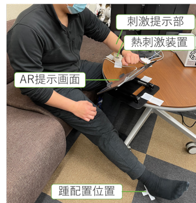
図 2: 実験の様子; 熱刺激提示部, 熱刺激装置, AR 提示用 iPad, 踵配置位置
