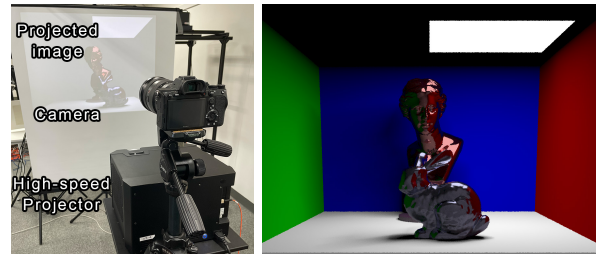
図 3: 左: スクリーン投影のシステム構成. 右: レンダリングしたシーン. 投影像をレンダリングする際には後方と左右の壁は描画せず, 間接光のみを計算する.
