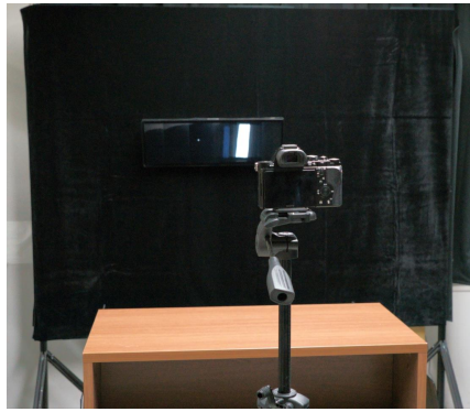
図 4: 実験システムの外観。台の後ろ部にディスプレイが配置されている。
