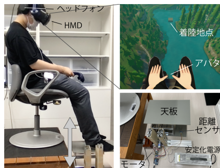
図 1: 浮遊感覚提示システム
