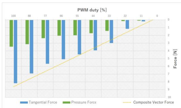
図 6：1 節のモータを回転させた時の出力 (せん断提示)
