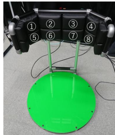
図 3: 使用する歩行装置および荷重センサ取付位置
