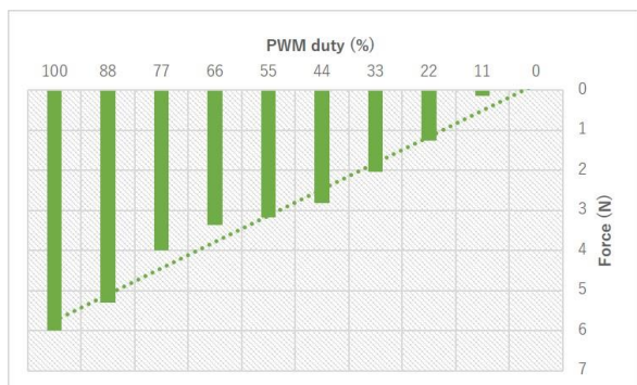
図 5 : 2 節のモータを異なる方向に回転させた時の出力 (圧覚提示)
