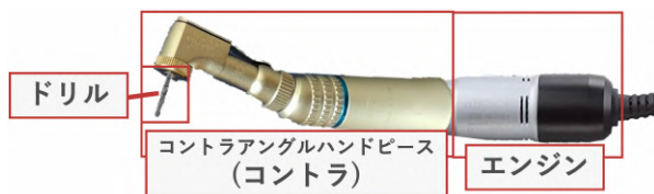
図 1: ドリル, コントラ, エンジンの構成
