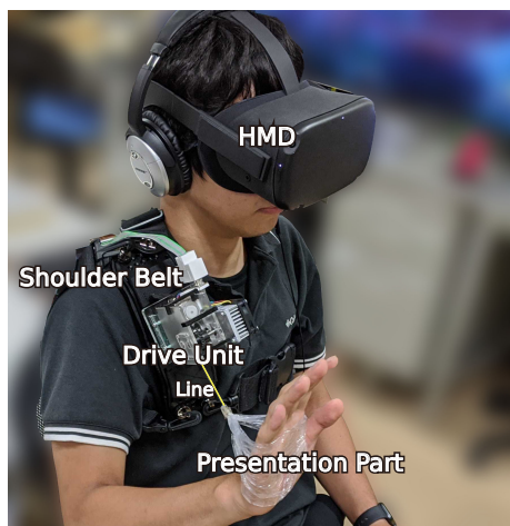
図 2: 撃力提示装置及びその身体装着例
