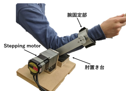
図 3 受動運動のための前腕駆動装置
