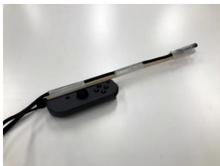
図 1: センサーを取り付けた内視鏡
