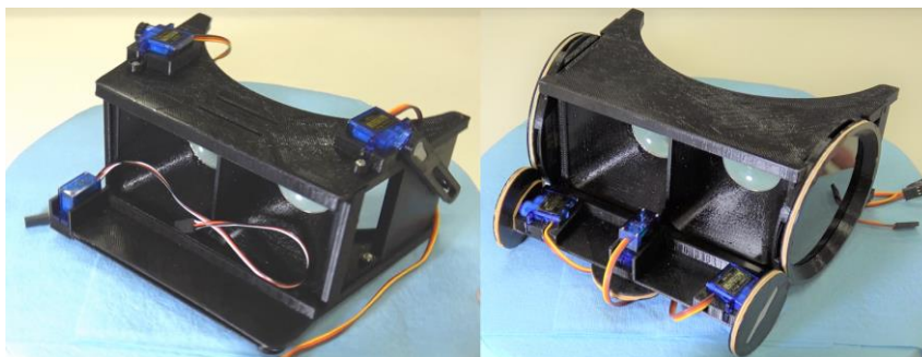
図 1: 開閉扉型 HMD (左) と透過扉型 HMD (右) の外観
