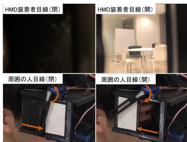
図 2: 開閉扉型 HMD の内部と外部からの見え方
