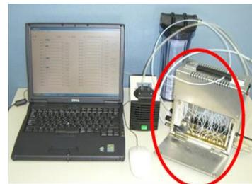
図 1: 高速開閉電磁弁式嗅覚ディスプレイ
