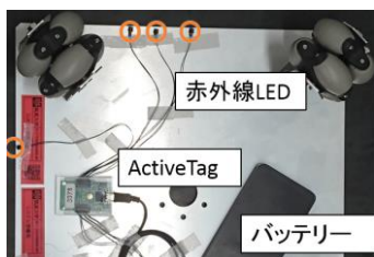
図8 ActiveTag とバッテリーの設置方法
