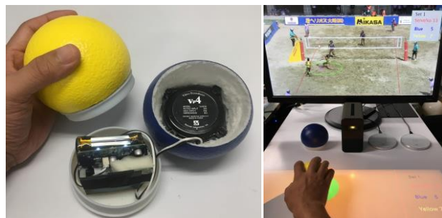
図 1: ボール型デバイスの外観および内部(左)とスポーツ中継用ハプティックインターフェースの実施例(右)
