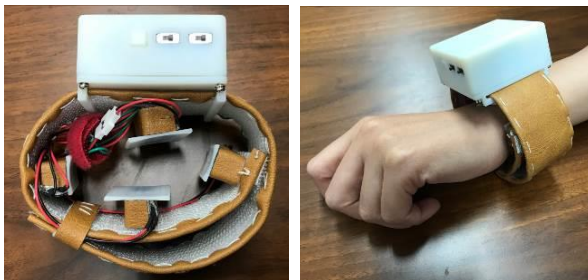
図1：リストバンド型ハプティックデバイス概観
