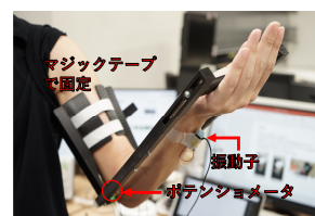
図5: 被験腕への振動子および角度測定装置の装着
