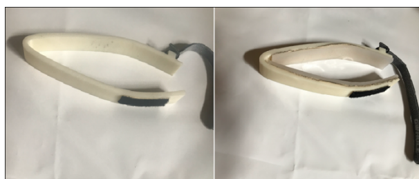
図 1 足首ハンガー反射デバイス. (左)シリコン無し, (右)シリコンあり
