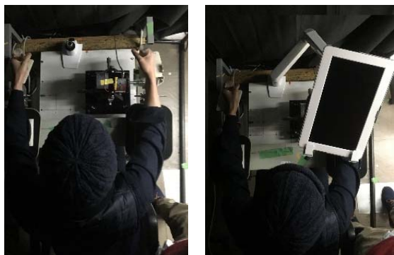
図 1 実験装置 (左: 運動錯覚呈示装置と左手再現装置, 右: RHI のために LCD ディスプレイを設置したところ)
