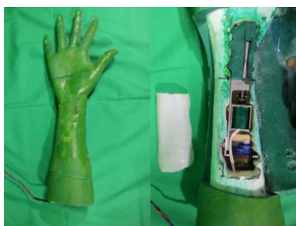
図2：脈拍機構を埋め込んだ右腕の模型
