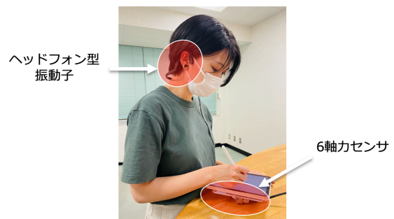
図3: 実験の様子（ヘッドフォン型振動子装着時）
