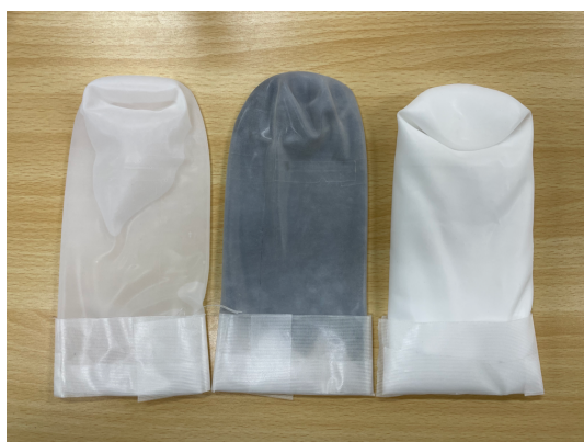
図7 シリコン素材による足裏素材サンプル
