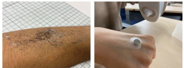
図 3: 触覚提示を行うデジタルスキンインタフェース。(左): 砂鉄を用いた試作 (右): 薄膜内に永久磁石を固定した試作
